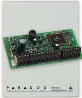
**DGP2-ACM1P : Module de contrôle d'accès**
