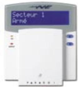
Module de clavier à ACL bleu de 32
